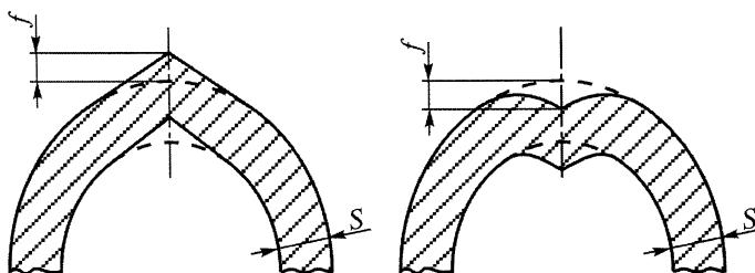
5.5.41. Допускаемые отклонения размеров в выпуклых днищах:
